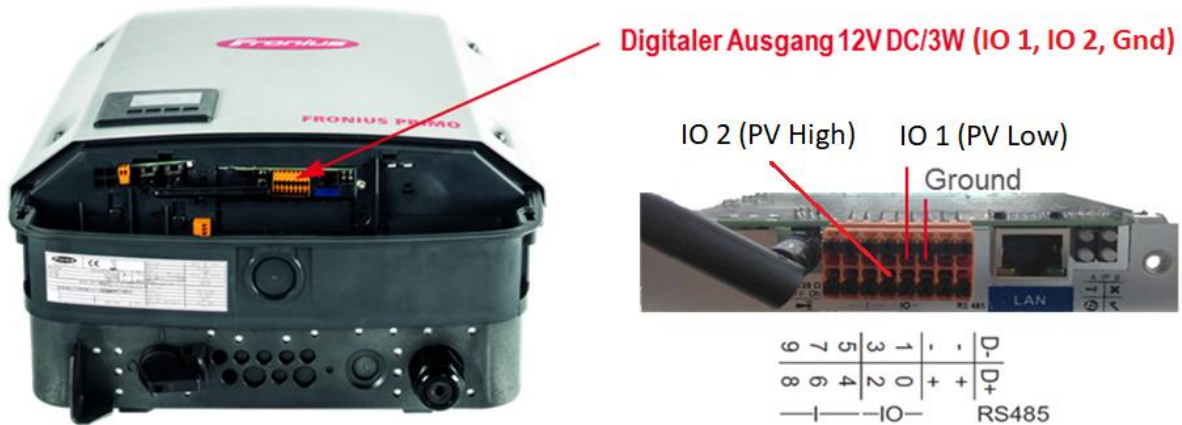
Abbildung 2: Anschluss am Fronius Datamanager 2.0 für das Lastmanagement.
