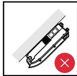
Não montar o inversor suspenso com as conexões para cima.
