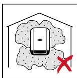
Por via de regra, o inversor é equipado à prova de poeira. No entanto, em áreas com muita poeira pode ocorrer o acúmulo de poeira nas superfícies de arrefecimento, afetando o desempenho térmico. Neste caso é necessário realizar uma limpeza regularmente. Por isso, não é recomendável a montagem em locais e ambientes com muito acúmulo de poeira.
