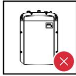
Não montar o inversor com as conexões para cima em uma parede ou coluna vertical.
