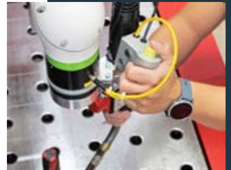
Einfache Schweißpfadprogrammierung durch direkte Brennerführung
